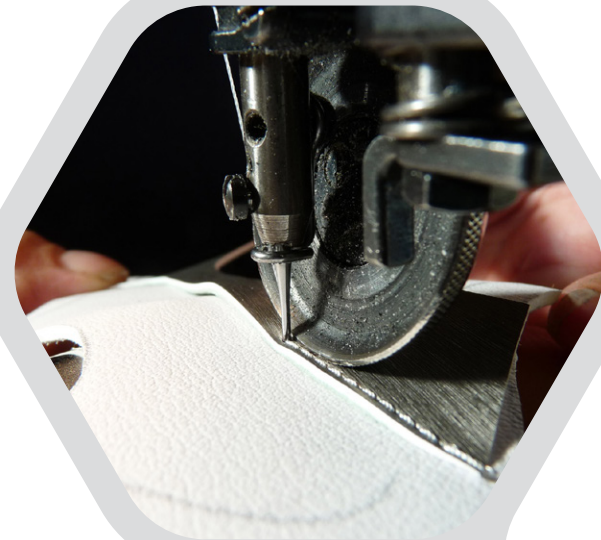
Steppen des Schuhoberteils Stitching of the upper
