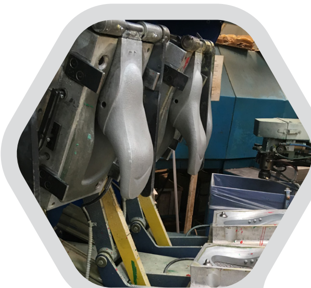
Herstellung eines PU-Clogs manufacturing of PU-clogs
